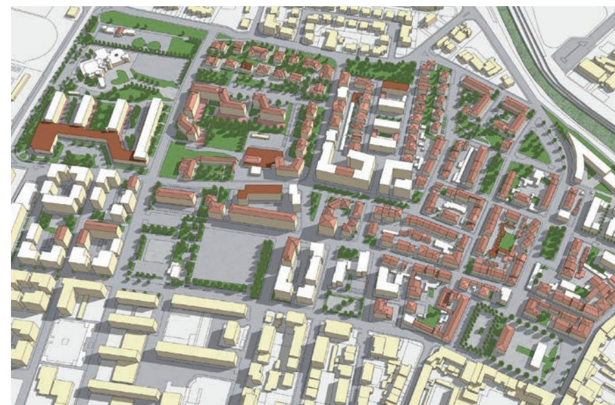
Fig. 4. Simulazione degli interventi praticabili sulle superfici dell'area campione ai fini della mitigazione dell'effetto "isola di calore" (elaborazione: Giulia Guerri).
