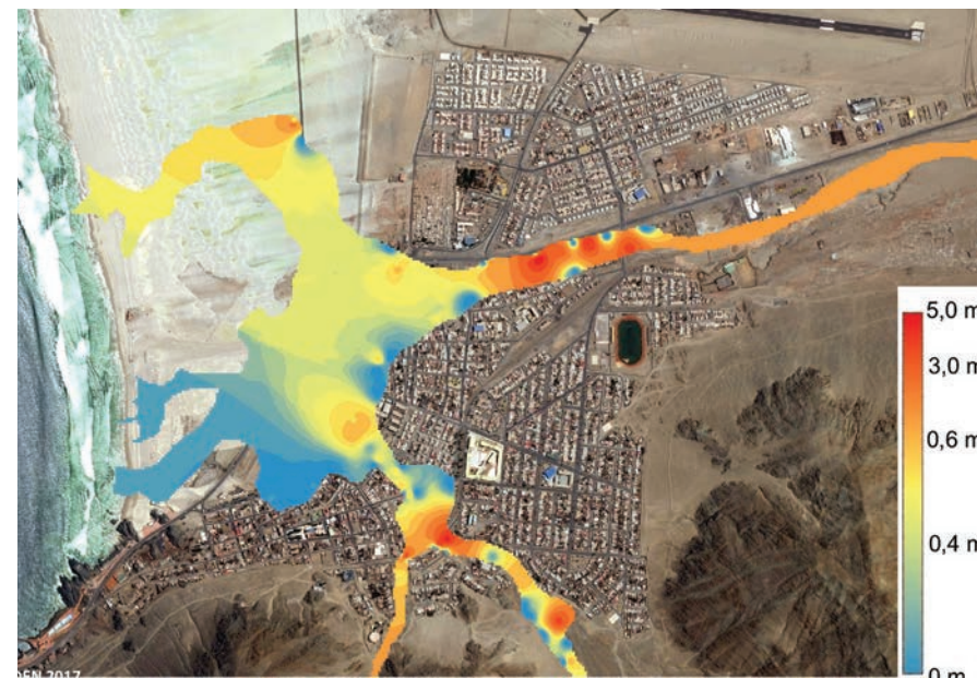
Fig. 5. Studio di rischio alluvionale, Chañaral (elaborazione CIGIDEN).
