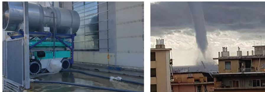
Fig. 2. TCLab del Building Future Lab. Test simulazione “uragano” in ambiente urbano (fonte: ricerca PRIN 2015).
