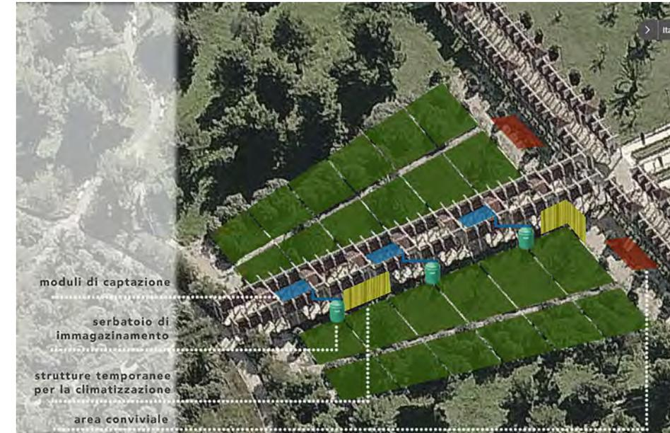
Vista del sistema complessivo per la gestione sostenibile dell'acqua di supporto all'orto sociale: moduli di captazione e di accumulo, strutture per l'ombreggiamento e ventilazione naturale, aree per la convivialità / View of the complete system for the sustainable management of water in the social garden: collection and harvesting volumes, structures for shading and natural ventilation, social aggregation areas (courtesy of Abita A.).
