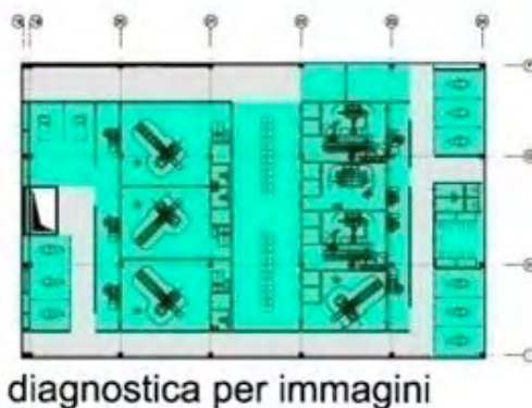
02 | Schemi del progetto modulare di un'area per ambulatori e di una diagnostica per immagini, Techint spa, Healthcare department Schemes of the modular project for an outpatient clinics and diagnostics' area, Techint spa, Healthcare department
