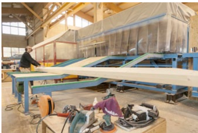
05 | Processo di produzione di elementi in legno, realizzati con macchinari a controllo numerico nello stabilimento di LignoAlp a Nova Ponente (Bolzano). Foto di LignoAlp Manufacturing of wooden building elements by numerical control machines at LignoAlp factory, Nova Ponente (Bolzano). Photo courtesy of LignoAlp.
