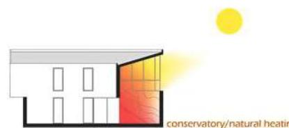
*Sezioni dell'alloggio tipo – La serra ha una doppia valenza sul piano energetico. Da un lato funge da sistema di riscaldamento passivo d'inverno, mentre dall'altro diventa un canale di ventilazione che sfrutta i moti convettivi grazie alla circolazione delle correnti da nord che arrivano dalla corte*
