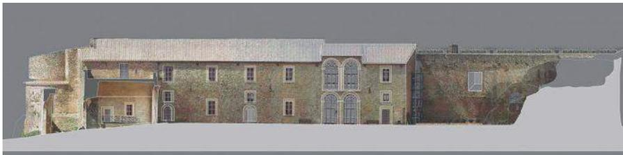
Rilievo del castello di Vibo Valentia, sezione longitudinale e prospetto della corte interna. Tesi di laurea di R. Moscato, relatore F. Fatta, correlatore A. Manti. Scansione laser A. Manti
