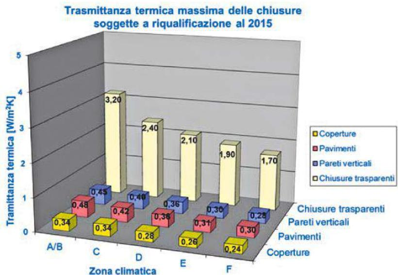
Figura 2. Valori limite della trasmittanza termica al 2015
