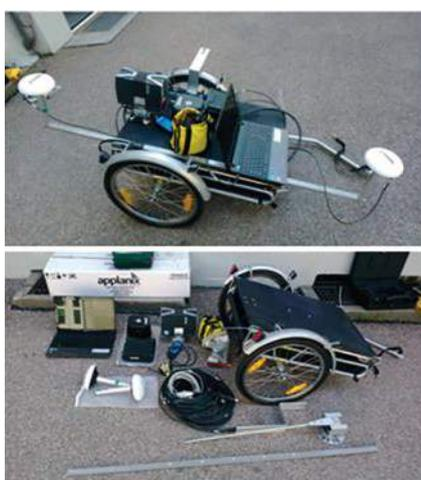
Sistema per rilevamento dinamico FARO Focus 3D con sistema a due antenne GPS, odometro, IMU, POS LV220 GAMS sviluppato da Applanix. Master tesi Ann-Kathrin Kinscher, in cooperation with Faro, Applanix and Tobias Moehlihs
