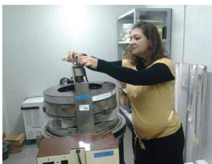
Attrezzatura di laboratorio per la determinazione delle caratteristiche termiche dei materiali: metodo della piastra calda con anello di guardia
