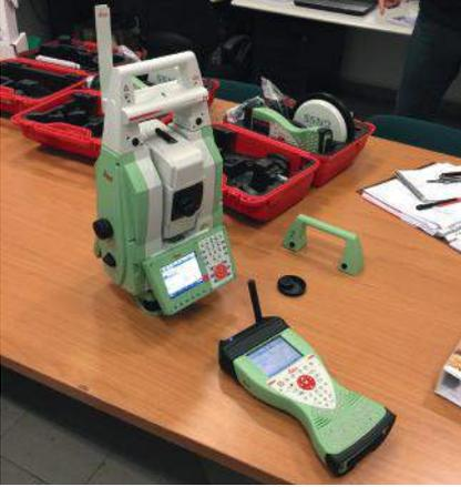
Figura 1. Leica Nova MS50 Multistation (stazione totale con integrato il laser scanner)
