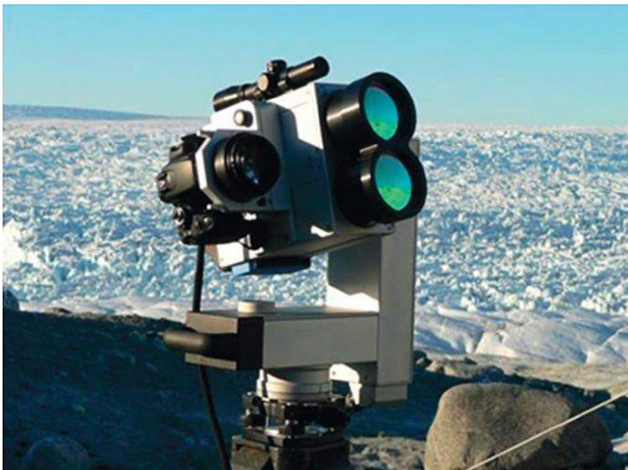
Very long range Laser Scanner: RIEGL LPM-321 con portata fino a sei chilometri
