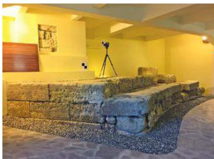
Figura 5. Operazioni di rilievo effettuato con il laser scanner
