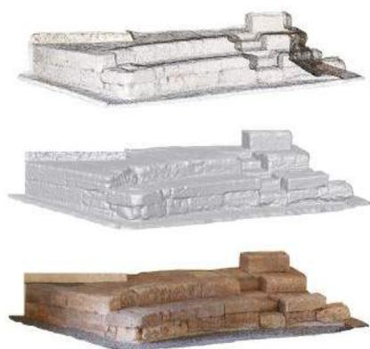
Figura 6. Modelli tridimensionali: point cloud, modello poligonale e modello texturizzato
