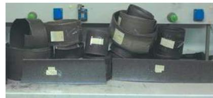
Figura 1. Compositi ottenuti per estrusione con testa planare di miscele di fibre di ginestra con polipropilene
