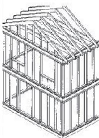
Il collegamento delle pareti dei piani successivi al solaio di interpiano avviene sempre con la stessa metodologia prevista anche per il sistema a pannelli portanti, ossia *hold-down* interni o bande forate esterne per il ribaltamento e viti di collegamento del corrente inferiore delle pareti superiori al solaio inferiore per lo scorrimento.
