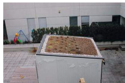
*Simulatore verde pensile (struttura realizzata appositamente per gli scopi di ricerca)*
