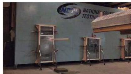
*Impact & Cycling test. Prove effettuate da GLASBILT srl su vetro stratificato fisso secondo le norme tecniche USA ASTM E1996 ed E1886*
