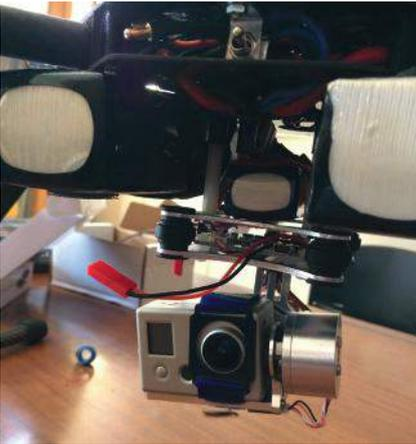
Figura 2. Particolare della fotocamera digitale fissata al drone
